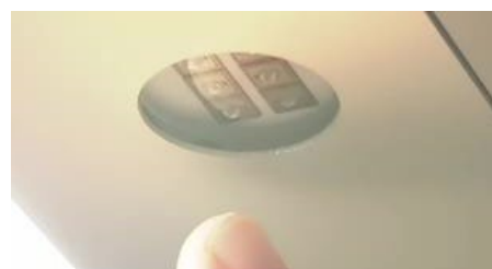
Abbildung 5: 600 mW UVC-LED Modul im Binz RESCUBE 3 (Fraunhofer IOSB-AST / Binz automotive)
