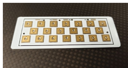
Abbildung 3: 2.1 Watt UVC-LED Modul 265 nm (Fraunhofer IOSB-AST)
