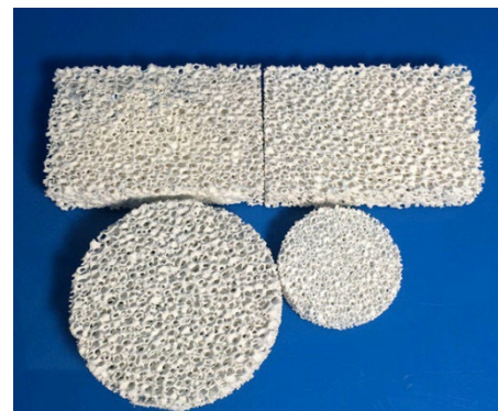
Abb. 4: \text{TiO}_2 -beschichtete Keramikschäume zur Luft und Wasseraufbereitung (IOSB-AST)
